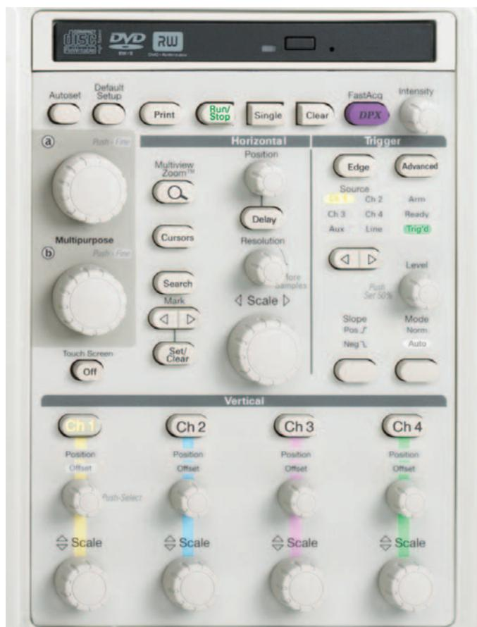
Abbildung 20. Bedienelemente auf dem vorderen Bedienfeld eines Oszilloskops.
