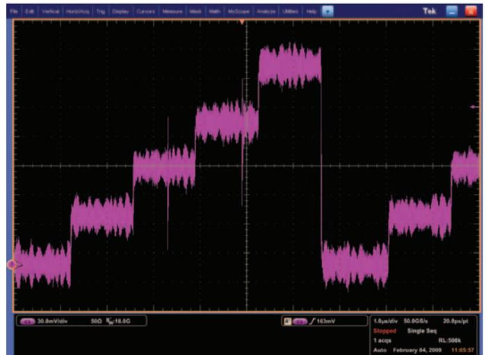
**Abbildung 24.** Mit dem Spitzenwerferfassungsmodus kann das Oszilloskop extrem kurze transiente Anomalien erfassen.
