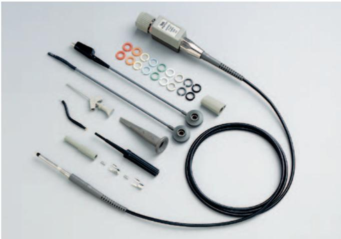
Abbildung 40. Ein üblicher passiver Tastkopf mit Zubehör.
